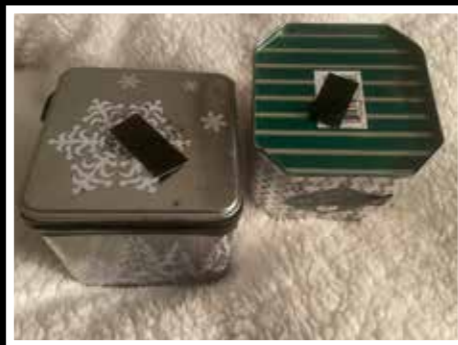
Cámaras estenopeicas elaboradas de latas metálicas de galletas Utilización de papel fotográfico
