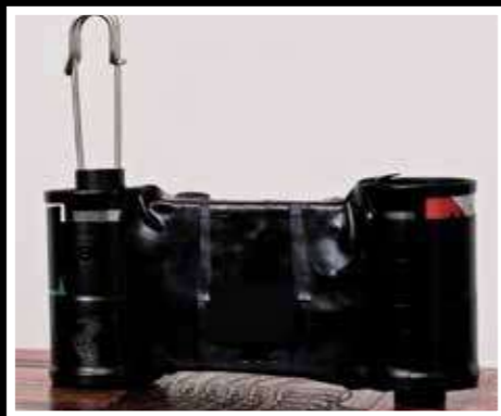
Cámara elaborada con cajetilla de cigarros Uso de película formato 35mm
