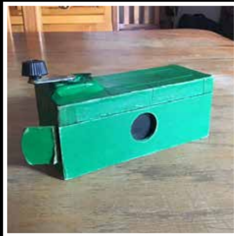
Cámara Acacia 154 de cartón, elaboración propia Uso de película de 35 mm
