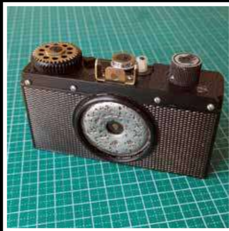
Conversión de cámara soviética Smena 8M a estenopeica Kodak Ektar 135 film
