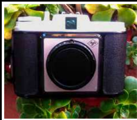
Cámara M0 Pinhole adaptada a partir de una cámara Agfa. Formato 120 mm
