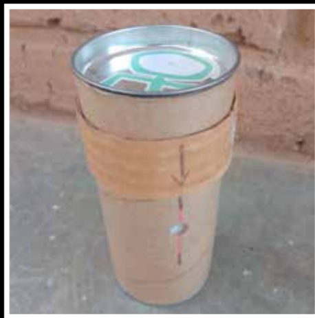
Cámara realizada con bote de cartón y tapa metálica Uso de papel fotográfico
