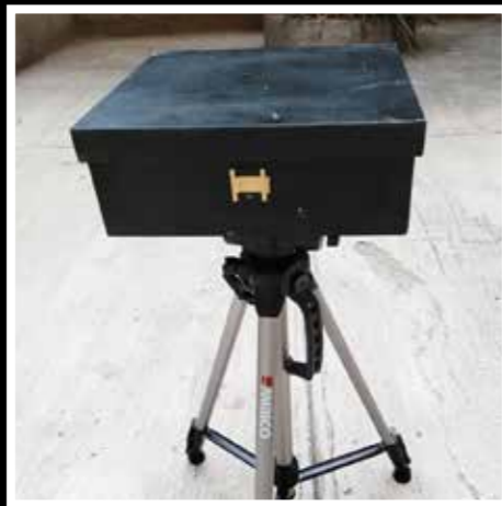
Cámara elaborada con cartón Uso de papel fotosensible, positivado digitalmente
