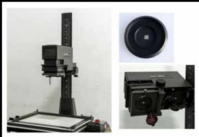
Amplificadora con estenopo y papel fotográfico Ilford
